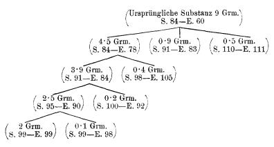
In diesem Fractionirungsschema bedeutet S den Schmelzpunkt in Celsiusgraden bestimmt nach der Methode von Piccard; im Haarröhrchen sind die Schmelzpunkte nicht genau zu ermitteln, da die Substanzen erst allmälig durchscheinend und erst bei höherer Temperatur völlig durchsichtig werden. Die Erstarrungspunkte sind hingegen im Haarröhrchen leicht zu bestimmen und in obigem Schema mit E bezeichnet.
